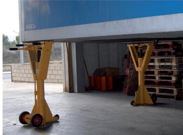
6. Una vez realizados los pasos anteriores, pasar a ajustar la altura del soporte a la medida requerida por el remolque:
